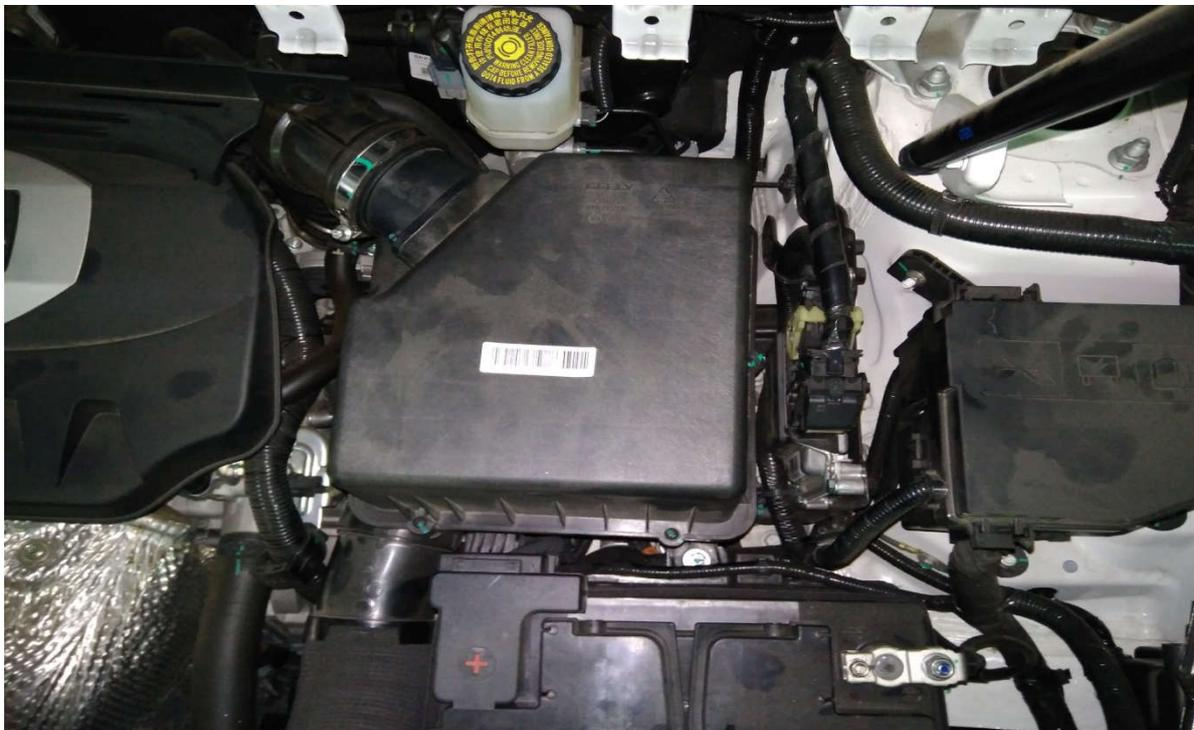
3. Установить защиту на блок управления двигателем.
